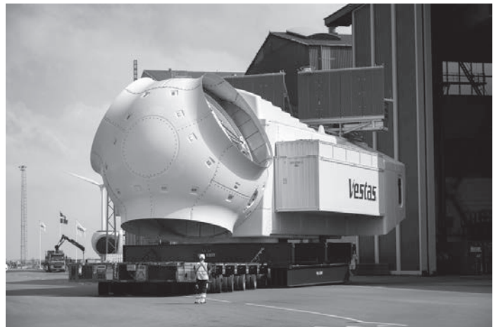
15MW風車のナセル (ベスタス提供)
